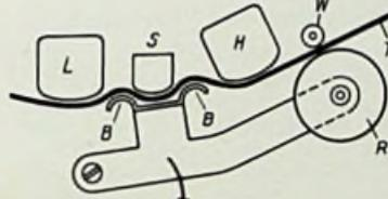
Bild 4. Arbeitsweise von Andruckrolle und Bandanlegebügel
