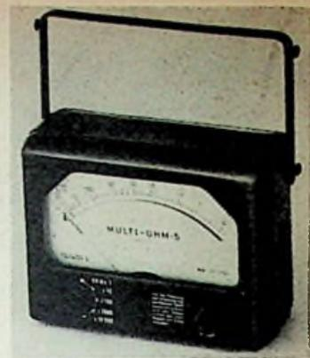
Bild 3. Vielfach-Ohmmeter mit Traggriff
