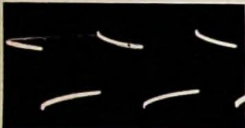
Bild 12. Dachschräge einer 50-Hz-Rechteckfrequenz bei einem Video-Verstärker
